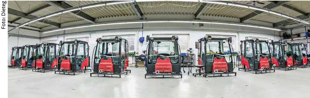
Hauptprodukt von Dieteg sind Arbeitskabinen, beispielsweise für Industriefahrzeuge. Im Bild ist die Endmontage zu sehen.
