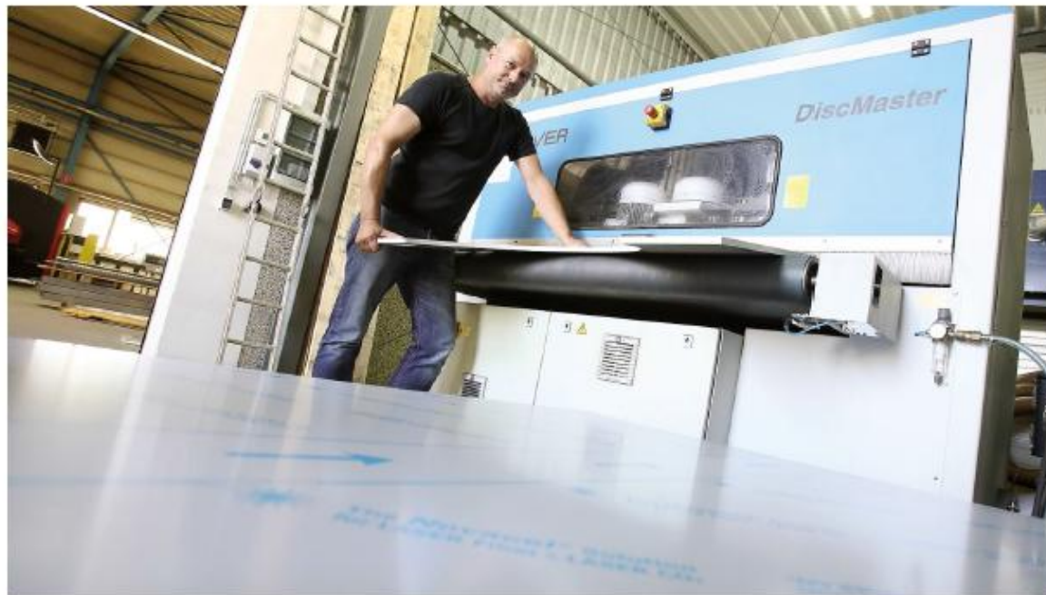
Stephan Mensler an der vollautomatischen Entgratanlage in der neuen 100 m 2 großen Halle.
