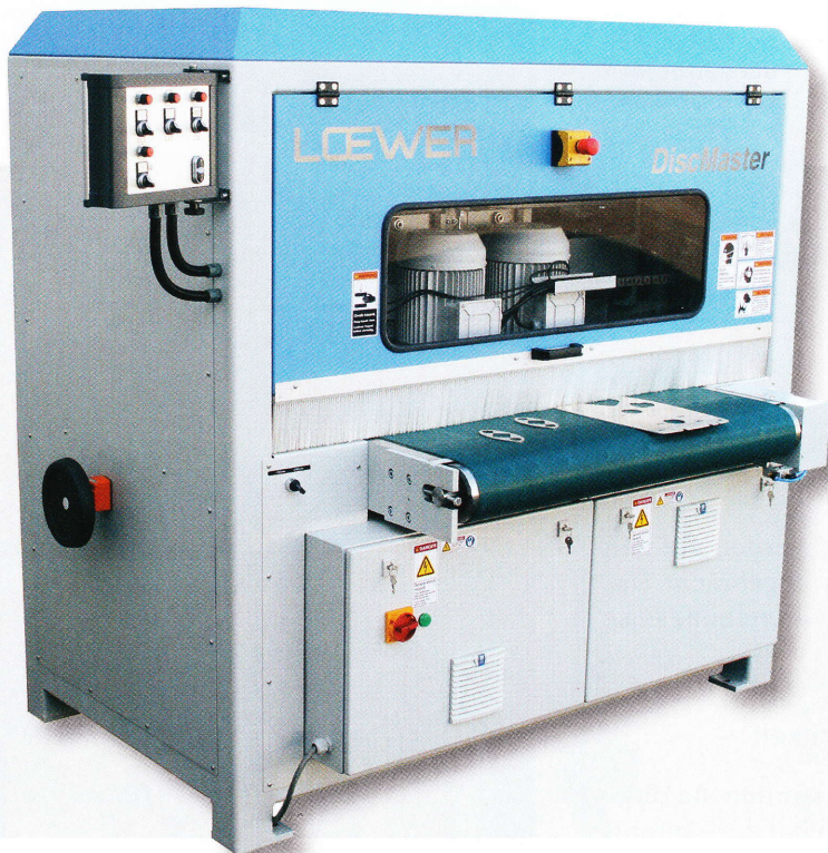
Die Entgratmaschine „DiscMaster 4TD“ arbeitet im Trockenverfahren mit zwei Entgratscheiben und zwei Verrundungsscheiben, welche im Durchlauf mehrmals über das Werkstück oszillieren
