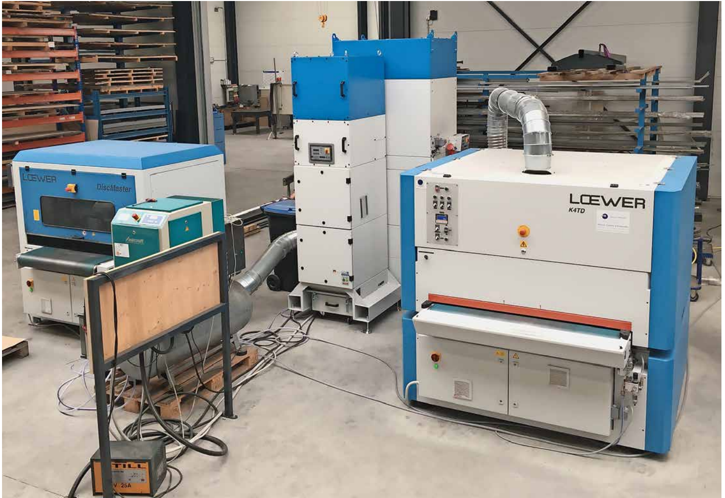
Die Blechentgrat- und Verrundungsmaschinen Disc Master 4TD und Belt Master K-4TD bei Fritzsich sind jeweils mit passenden Absauganlagen ausgestattet.
